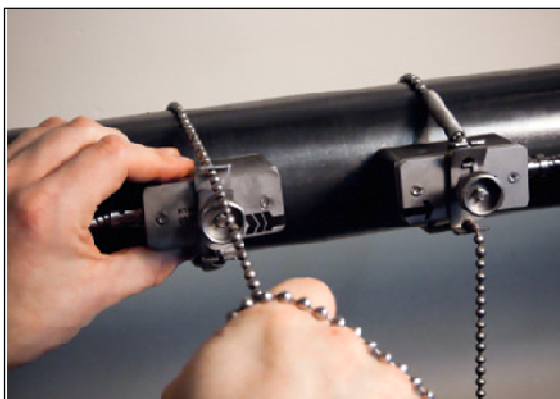
Namestitvev senzorjev s pomočjo vpenjal in verige
