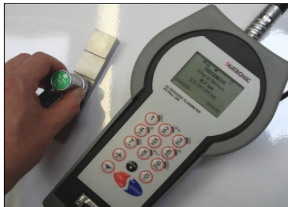
Sonda debeline stene skupaj s KATflow200
