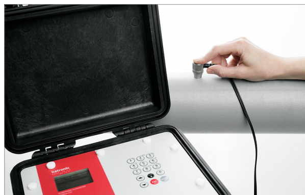
Sonda za debelino stene cevi NT in KATflow 210 v uporabi
