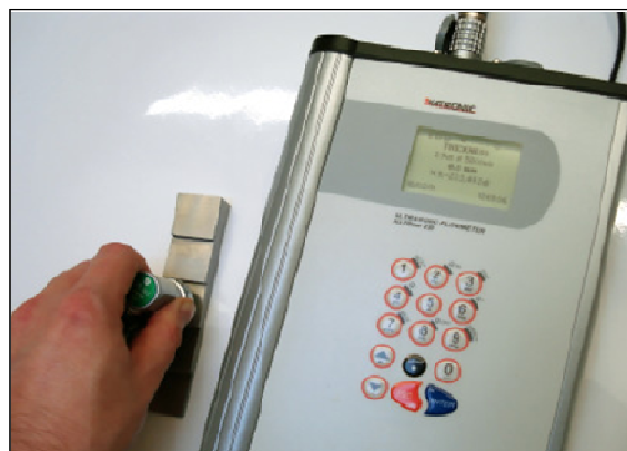
Sonda debeline stene skupaj s KATflow230
