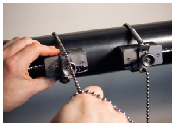
Namestitvev senzorjev s pomočjo vpenjal in verige
